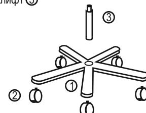
6. Сиденье установите отверстием в механизм ④ на газлифт ③.
